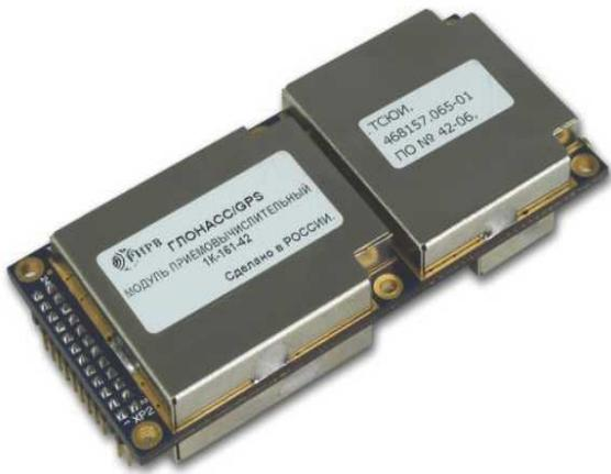
Навигационный приемник первого поколения спутниковых систем ГЛОНАСС/GPS 1К-161
