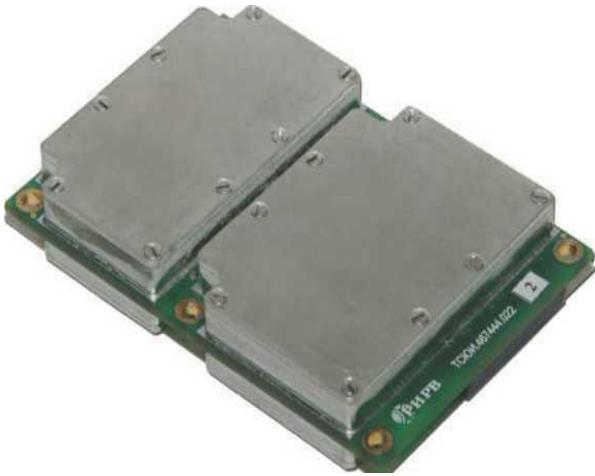
Работает по сигналам глобальных навигационных спутниковых систем ГЛОНАСС, GPS и сигналам систем SBAS. Предназначен для определения текущих координат и составляющих вектора скорости объекта, формирования шкалы времени, синхронизированной с заданной шкалой времени и регистрации радионавигационных параметров.
