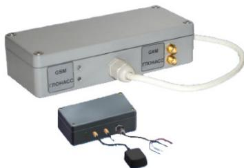
Через определенный промежуток времени объект выходит на связь с сервером через канал связи GPRS или BlueTooth, и передает заданные параметры.
