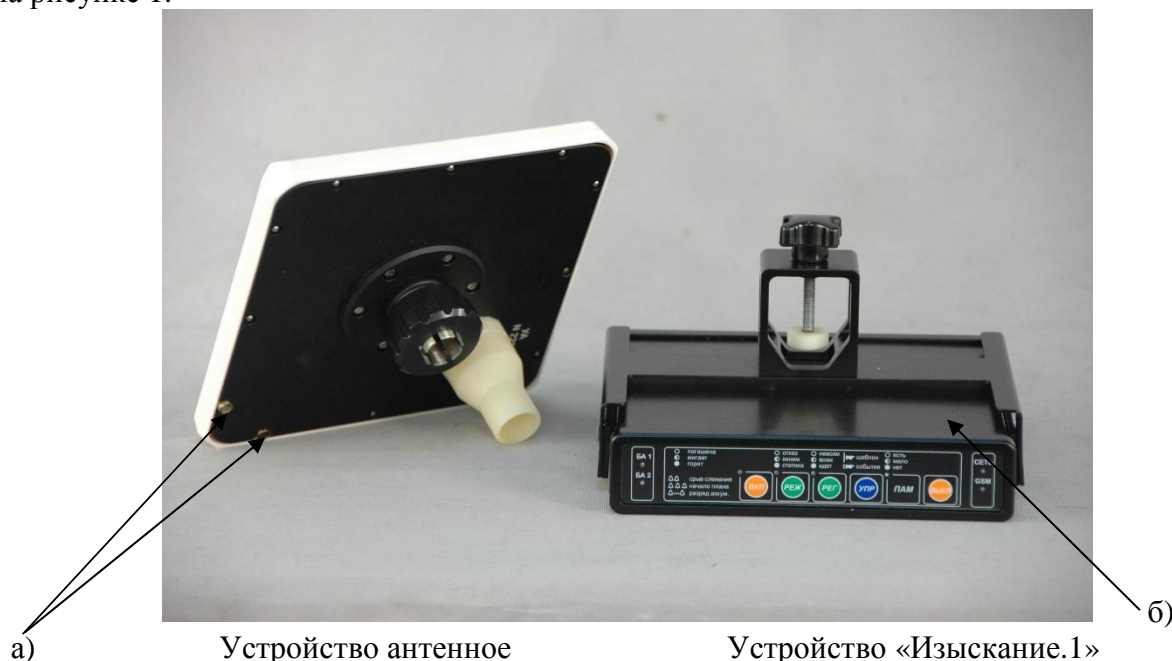
а – места пломбировки от несанкционированного доступа б – место нанесения наклейки со знаком утверждения типа Рисунок 1 – Внешний вид аппаратуры «ИЗЫСКАНИЕ»
