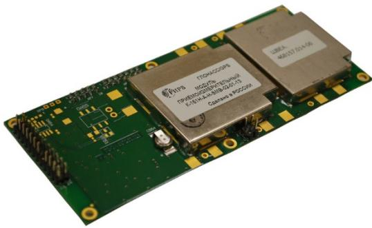
Работает по сигналам глобальных навигационных спутниковых систем ГЛОНАСС, GPS, WAAS, EGNOS. Предназначен для определения текущих координат и составляющих вектора скорости объекта, формирования шкалы времени, синхронизированной с заданной шкалой времени и регистрации радионавигационных параметров.
